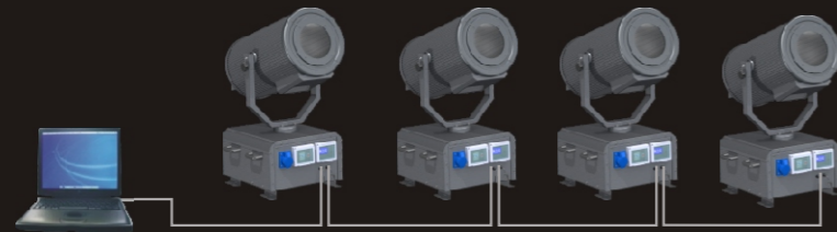
DMX512通讯同步方式: 主从机方式: (固定程序, 无控制器); 可编程序方式: (多种程序, 带脱机或联机控制器);
